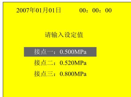
该值作为校验值的对比值。按‘上’‘下’键换行，按‘+1’‘-1’和‘左移’‘右移’键修改数值，按确认键保存所有新值并进入校验项目选择界面。
