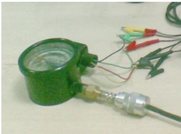
选择合适的接头连接测试仪表，判断仪表的触电，连接鳄鱼夹，鳄鱼夹的顺序参见附录。
