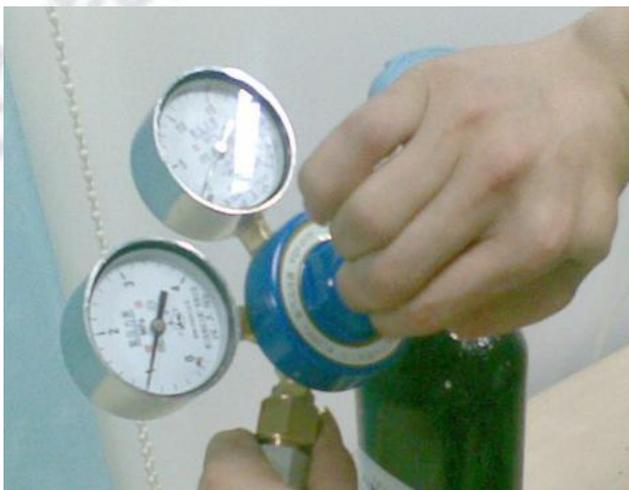
打开减压阀，使出气压力在 1MPa 左右
